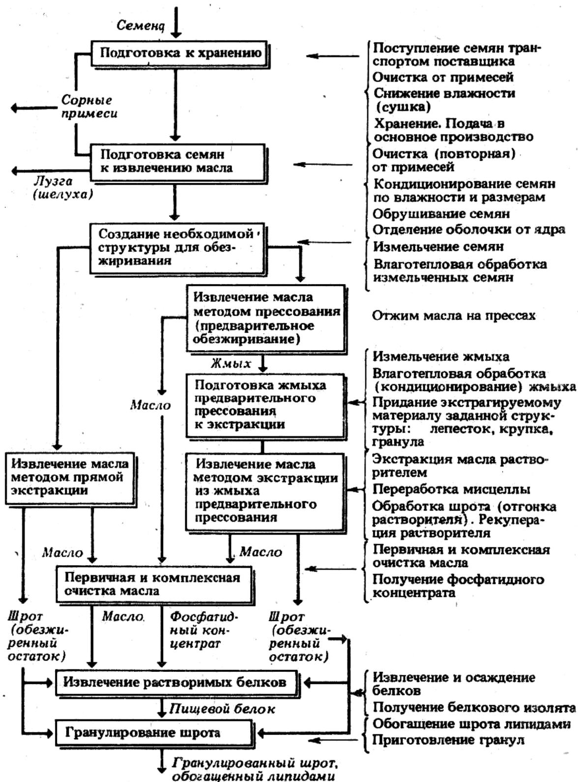
Рис. 1. Принципиальная структурная схема переработки масличного сырья
